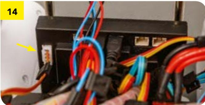
Возьмите коричневый/ красный/ оранжевый/ жёлтый жгут проводов с биркой M-C и вставьте его большую вилку в разъем M-C платы управления датчиками.
