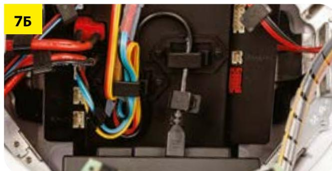
**7B** ...и вставьте вилку провода в разъём платы управления датчиками, помеченный буквами L-S.
