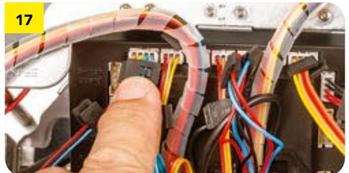
Вилку на другом конце проводов управления датчиками вставьте в разъем S-C микроконтроллера.
