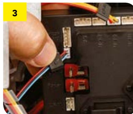
**3** Вставьте вилку проводов с биркой C-S в соответствующий разъём.
