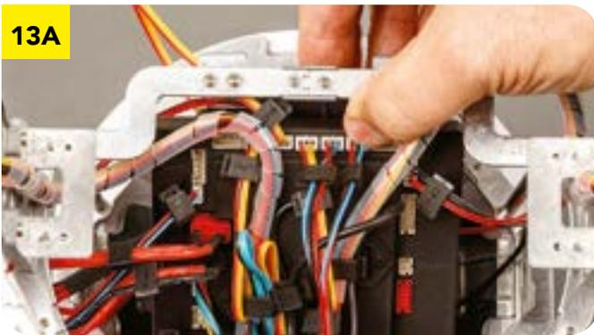
Спустите провода с биркой R.H-IR вниз и вставьте их вилку в соответствующий разъем микроконтроллера...
