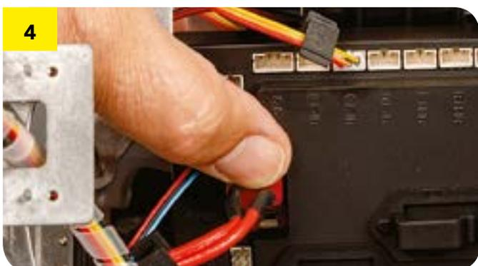
**4** Вставьте вилку проводов батарейного отсека с биркой ON-OFF в соответствующий разъём.
