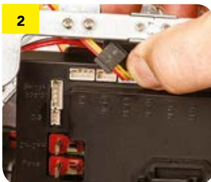
**2** Вставьте вилку проводов с биркой C.F-IR в соответствующий разъём.
