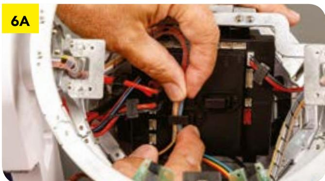
**6A** Провода, выходящие из левой опоры и идущие вниз, пропустите через указанный зажим на корпусе микроконтроллера.
