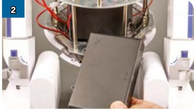
Доставайте отсек так, как показано на фотографии, чтобы получить доступ к двум саморезам, фиксирующим его крышку. Если у вас это не получается из-за проводов, то, возможно, вам следует немного их ослабить и снова вставить в разъемы.
