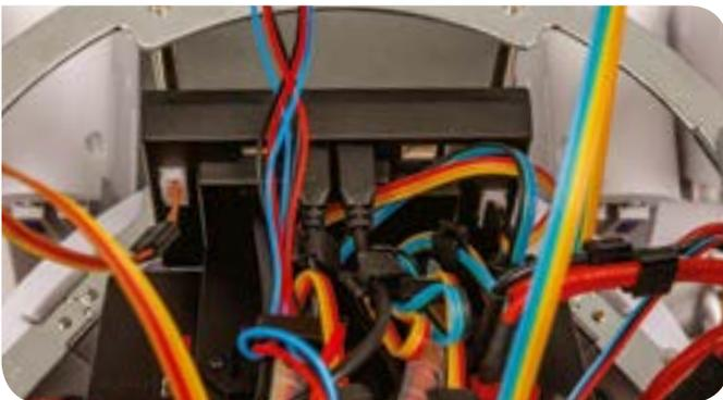
На этом подключение проводов к плате управления датчиками и микроконтроллеру завершено. Все провода должны быть подключены согласно схеме на стр. 11.
