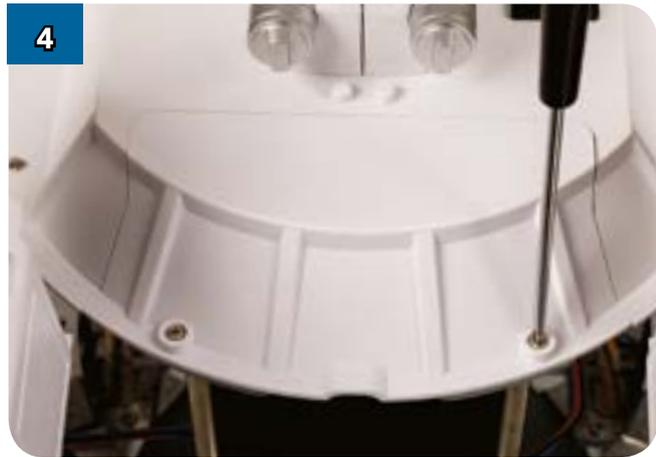
4 Выкрутите два винта, фиксирующие выдвигную панель...
