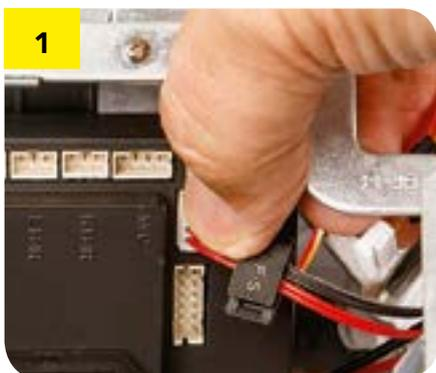
**1** Вставьте вилку проводов с биркой C.F-S в соответствующий разъём.
