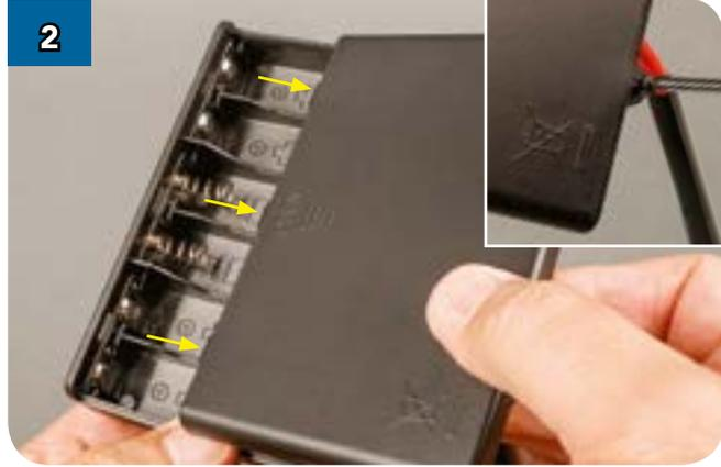
2 Наденьте крышку на своё место так, чтобы выступы, отмеченные стрелками, вошли в соответствующие прорези. Закрепите крышку двумя саморезами, закрутив их в отверстия в ушках.
