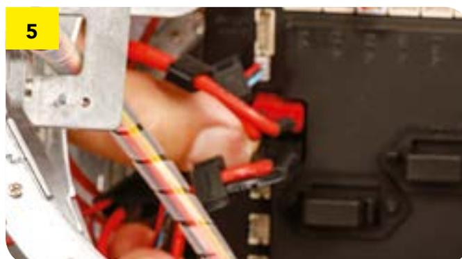
**5** Вставьте вилку проводов батарейного отсека с биркой Power в соответствующий разъём.
