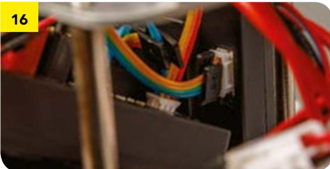
Возьмите голубой/ бирюзовый/ жёлтый/ оранжевый жгут проводов с биркой S-C и вставьте его большую вилку в разъем S-C платы управления датчиками.
